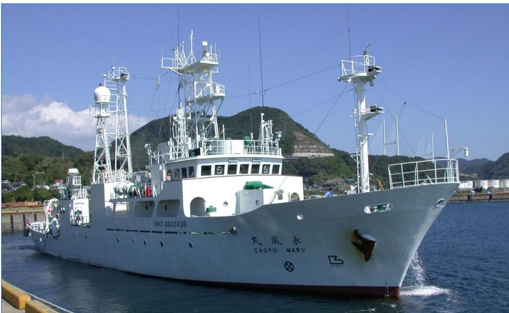
図5. 長風丸 II世（1987年2月20日竣工。総トン数480 t、全長56.0m、幅9.8m、速力11.5ノット）
